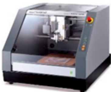
(d) Modeladora 3D MDX-40A com tecnologia SRP (Prototipagem Rápida por Subtração);
