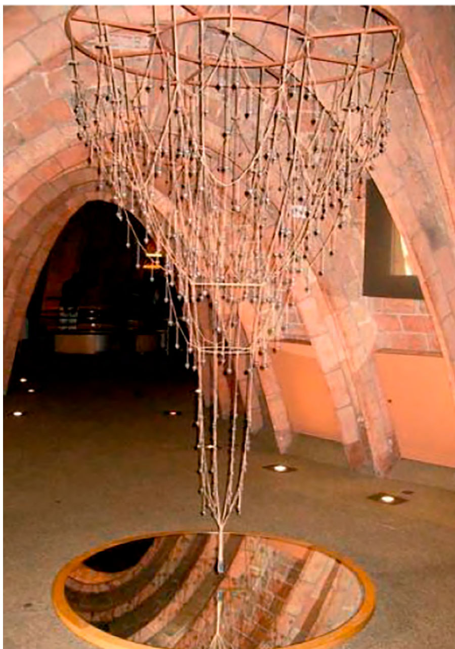
Figura 1. Estudo das forças de Gaudi. Batizado por Catenária (Catená, do latim significa corrente, ou seja, formato da corrente suspensa), no Museu de Gaudi. Fonte: autora.
