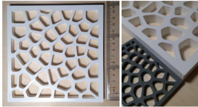
**Figura 15:** Outputs do esqueleto interno de uma prancha de surfe oca. Fonte: Araújo (2021).
