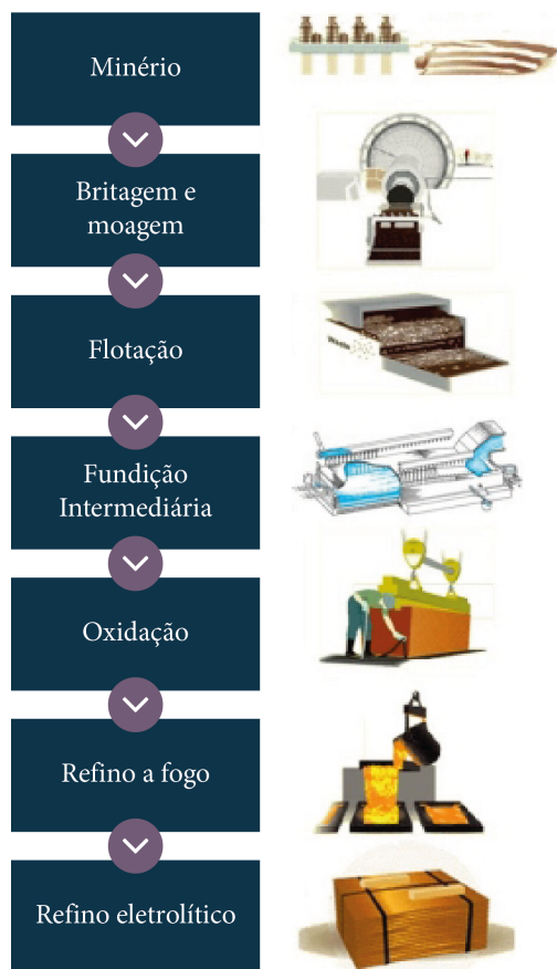
Figura 1.2 – Sequência de obtenção do cobre, do minério até o cátodo de cobre.
