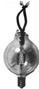
Figura 2.8: Válvula Termoiônica Audion, obtido de wikipedia.org/wiki/Audion .
