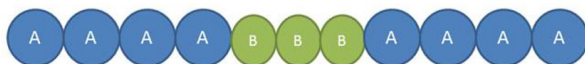
Figura 12.5 – Ilustração de polímeros anfifílicos em bloco das unidades monoméricas A e B.
