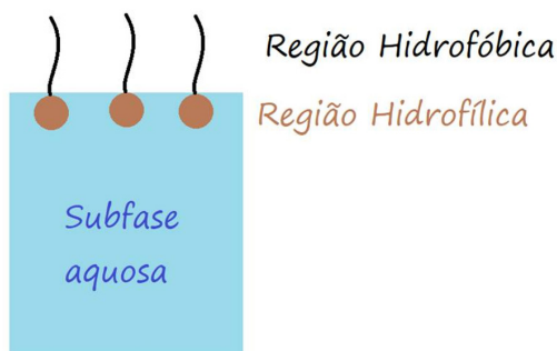
Figura 12.9 – Compostos anfifílicos aderidos à interface ar-água. Representação das moléculas de tensoativo adsorvidas na interface líquido-ar e líquido-líquido (água-óleo).
