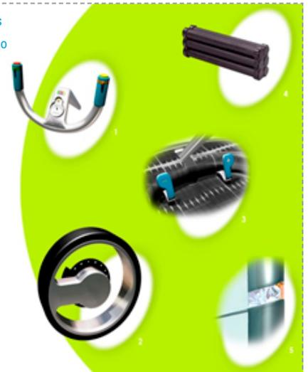
A travagem permite a recuperação da energia que é depositada nas baterias. Os comandos do veículo encontram-se todos integrados no volante, com excepção dos dois pedais de aceleração e travagem que se posicionam na base superior da estrutura principal, na zona próxima dos pés do condutor.<sup>Figura 11</sup>
