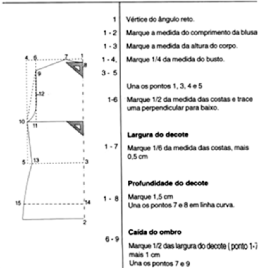
Figura 5. Instruções para elaboração das costas da Blusa SENAI. Fonte: CARDOSO, Ana Maria [et al.] (2001) - blusa de botões.
