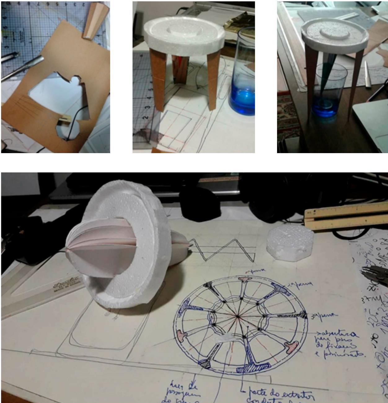
Figura 12. Parâmetros de medidas; mocape em isopor e em papel de impressora para estudo da forma do gomo do prato coletor; desenho e modelação 3D de mocape do ZeppJuice-I; definição das formas dos componentes do ZeppJuice-II.
