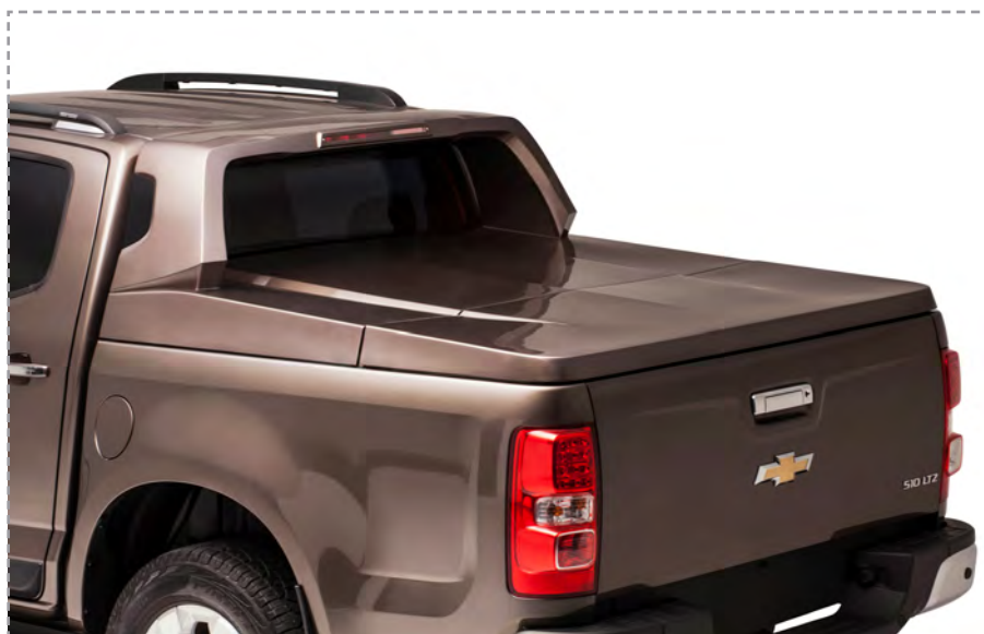
Figura 1. Capota HOOD S10. Capota em Fiberglass, produzida a partir do modelo tridimensional confeccionado manualmente. Fonte: Estúdio 566 Design e Magna Moldes. Design by Estúdio 566 Design. Foto: Cláudio Brandão.
