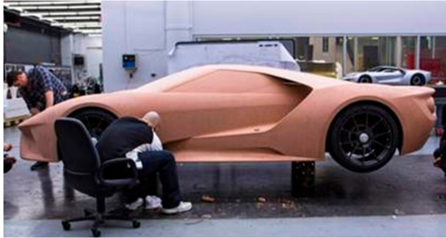
Figura 3. Modelo em clay. Fonte: https://media.ford.com/content/ford-media/fsa/br/pt/news/2017/08/23/ford-revela-uma-das-curiosidades-do-desenvolvimento-de-seus-carr.html
