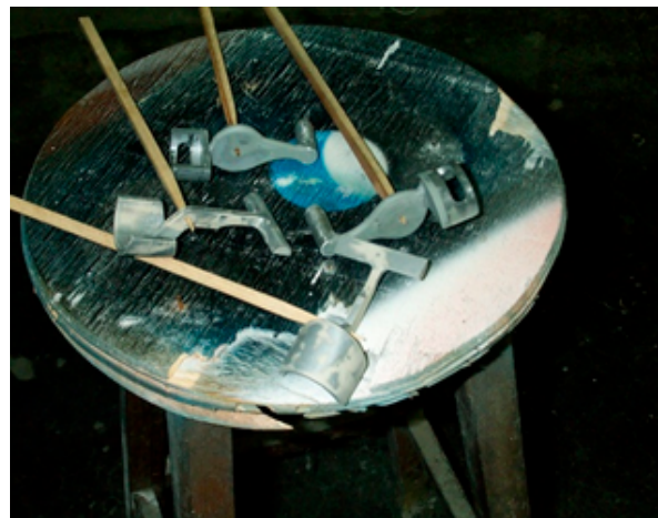
B. Peças fundidas antes da pintura
