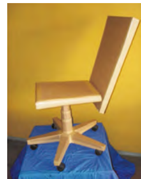
Módulo 5 - execução de mok-ups em papelão ondulado.
