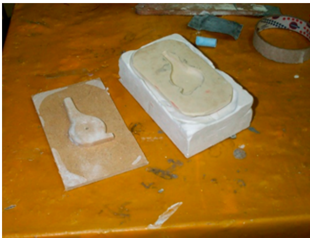
Figura 36 A. Molde aberto para fundição alumínio
