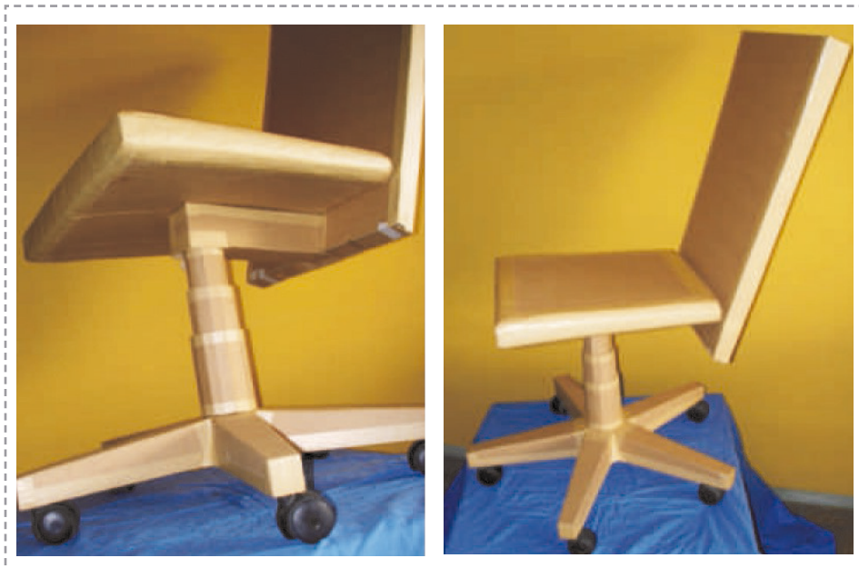
Figura 12D. Módulo 5 - desenvolvimento de mock-up em escala real através do papelão ondulado. Desafio de projeto: desenvolvimento de mobiliário para um escritório. Cada dupla ficou responsável por um mobiliário do escritório.
