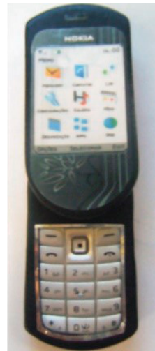
Modelo desenvolvido a partir de papelão pinheiro com acabamento em prime e esmalte sintético spray.
