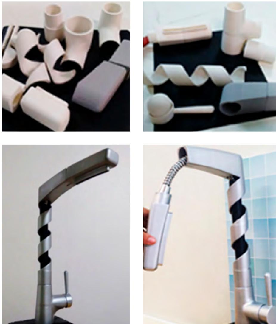
Figura 7 – Peças da torneira impressas e montadas. Fonte: PRONTO 3D.
