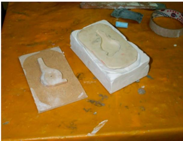
Figura 36 A. Molde aberto para fundição alumínio
