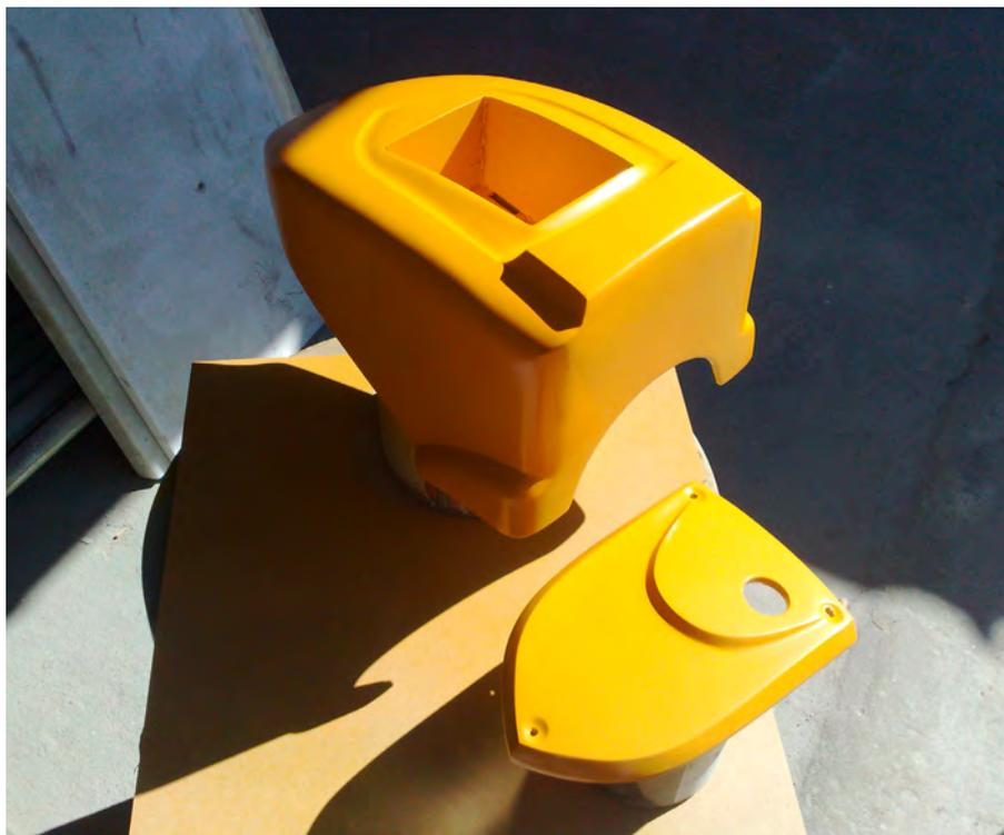
Quando o modelo não possuir mais porosidade na superfície, passe um pano úmido e aplique a tinta base (primer), lixe e finalmente aplique a tinta de acabamento na cor definida, recomenda-se o uso de tintas automotivas laca nitrocelulose, pois, secam mais rápido e são de melhor qualidade, conforme apresentado na figura 18 e 19 (Capota para S10 e Wap Lavadora de pressão).
