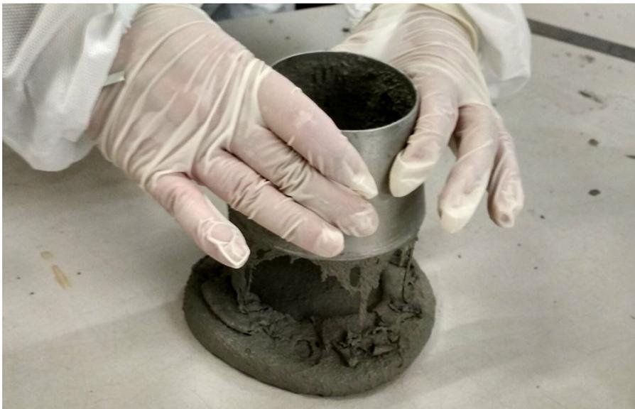
O ensaio de espalhamento consiste no enchimento de um molde cônico (Figura 29) com o material a ser testado que em seguida é levantado perpendicularmente à superfície em que se encontra apoiado. O material será então liberado, espalhando-se na superfície. Quando o movimento parar é medido o espalhamento provocado, encontrando-se o índice de deformabilidade da argamassa.
