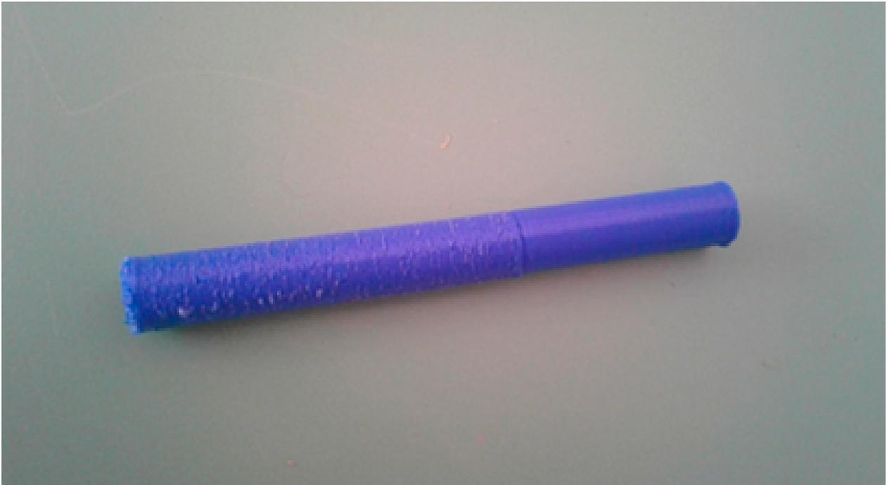
Esse defeito superficial pode ser removido através de processos de acabamento, contudo, em partes que exigem precisão como encaixes podem comprometer o protótipo. Sendo assim, essa limitação do processo deve ser considerada na etapa de projeto.
