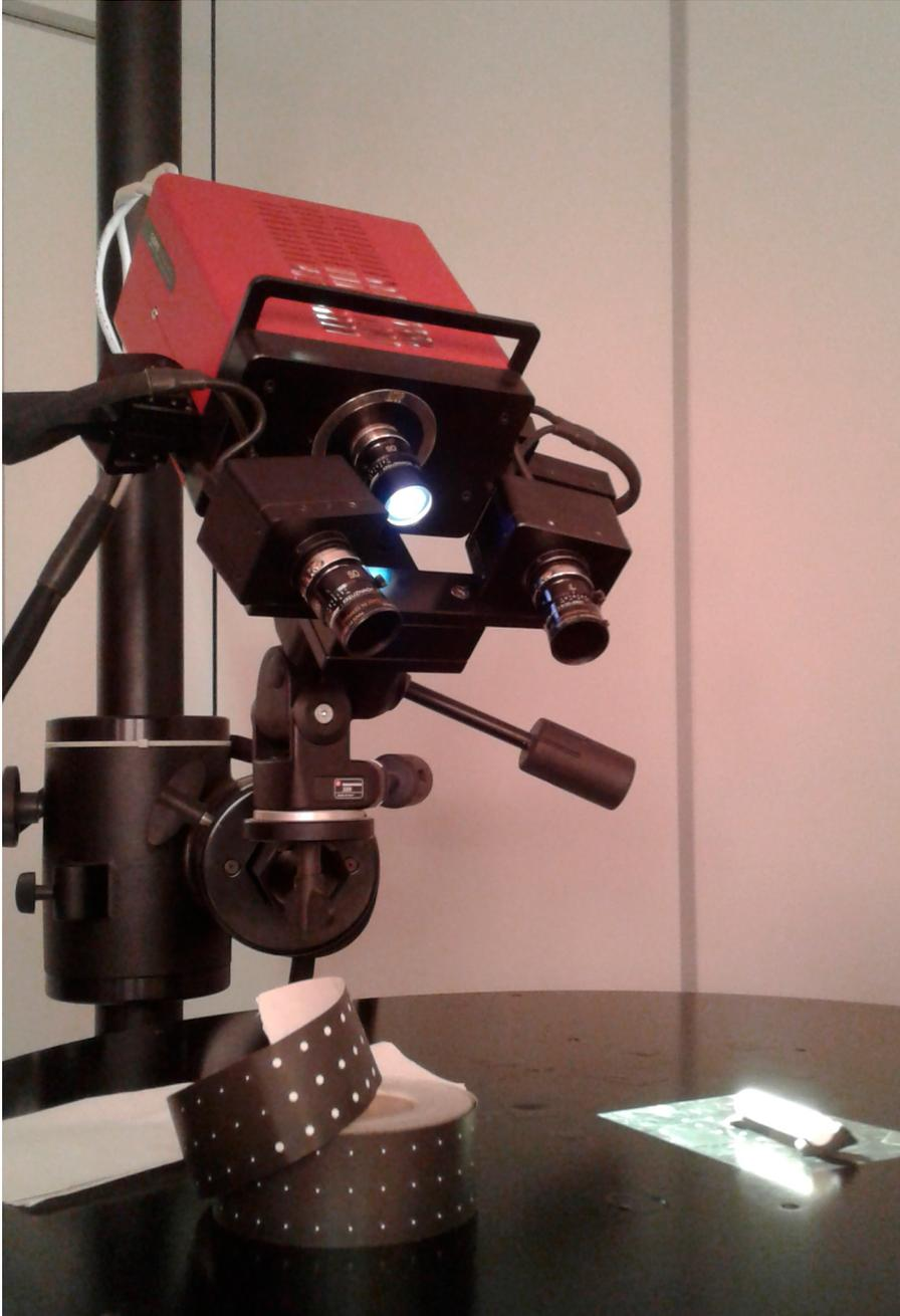
Com os modelos digitalizados, utilizou-se o programa *freeware* GOM Inspect<sup>12</sup> para executar os processos de inspeção, de maneira a comparar a precisão da superfície das peças em relação ao modelo gerado pelos Fusion 360 e Blender, gerando um mapa de cores no próprio renderizador em tempo real 3D e um diagrama da variação superficial.
