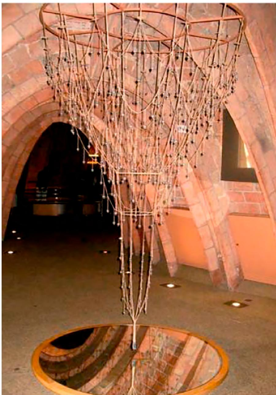
Figura 1. Estudo das forças de Gaudi. Batizado por Catenária (Cadena, do latim significa corrente, ou seja, formato da corrente suspensa), no Museu de Gaudi. Fonte: autora.
