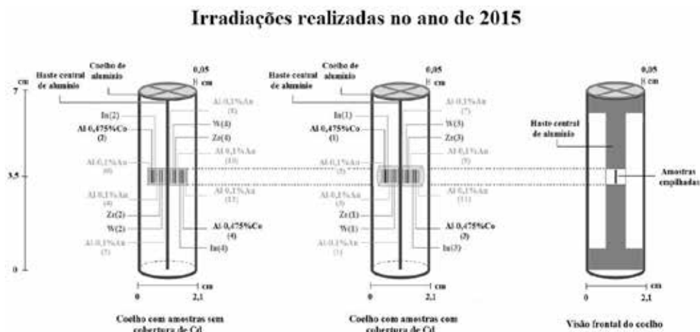
Figura 2 – Coelho preparado para as irradiações realizadas no ano de 2015 (a); com amostras sem cobertura de cádmio (b); com amostras com cobertura de Cd (c); visão frontal do coelho.
