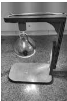
Figura 2 – Eliminação da fase líquida da amostra utilizando uma lâmpada de infravermelho.
