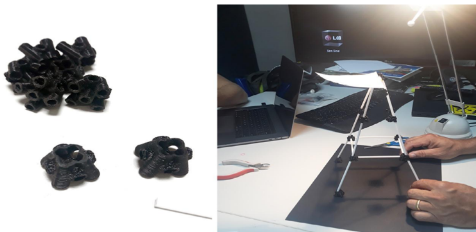
Figura 4: Modelos do Produto (escala 1:6) impressos (esquerda) e estudos de alternativas de montagem (direita)
