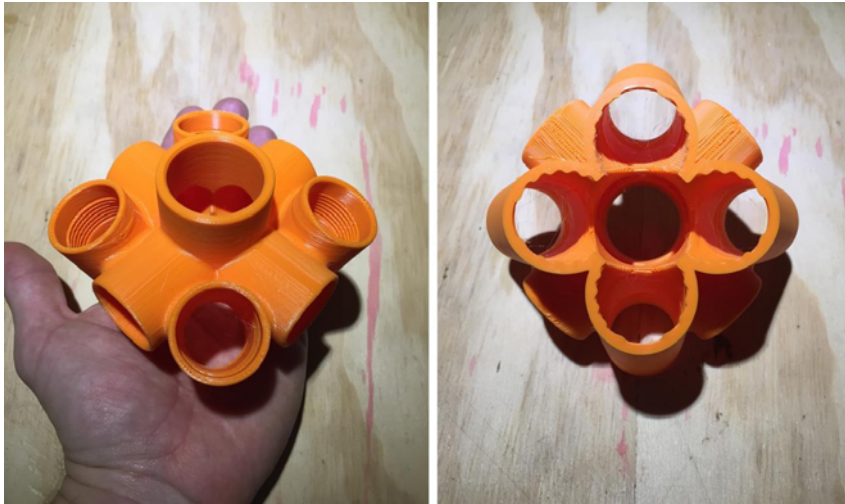
Figura 5: Versão final da nova conexão cocriada com o artesão e produzida por impressão 3D
