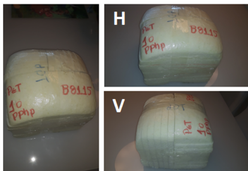
Figura 1. Um bloco de espuma de PU de 25x25x25 cm contendo 10% de PET micronizado fluorescente, ilustrando o fatiamento do bloco de espuma nos sentidos horizontal (H) e vertical (V) para obter os corpos de prova e avaliar a distribuição espacial da fluorescência.
