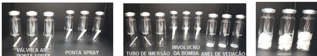
Figura 2 – Acondicionamento dos componentes individuais para análise por headspace em cromatógrafo a gás acoplado à espectrometria de massas
