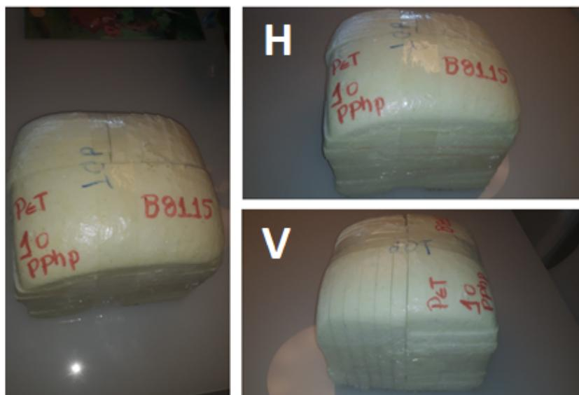
**Figura 1.** Um bloco de espuma de PU de 25x25x25 cm contendo 10% de PET micronizado fluorescente, ilustrando o fatiamento do bloco de espuma nos sentidos horizontal (H) e vertical (V) para obter os corpos de prova e avaliar a distribuição espacial da fluorescência.
