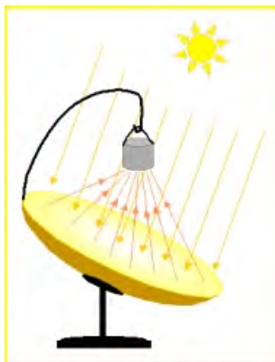
Figura 8.19: Representação do funcionamento de um fogão solar parabólico
