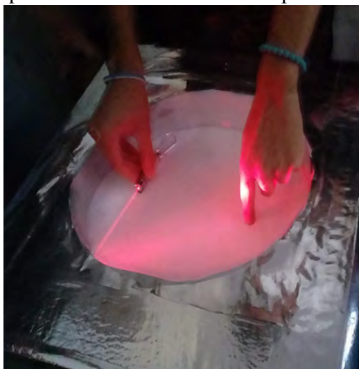
Figura 8.13: Experimento de reflexão numa superfície refletora elíptica
