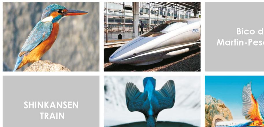
O projeto tem como referência a forma do bico alongado do pássaro Martim-Pescador, que facilita o mergulho sem espirrar água em busca de sua refeição. Visando solucionar um dos grandes problemas do trem bala, que reside na vibração e o barulho, o engenheiro buscou inspiração no formato do bico deste pássaro, o que resultou numa melhora significativa, tornando o veículo 10% mais rápido, consumindo 15% menos energia, e ainda, reduzindo a pressão do ar em 30% em relação ao modelo anterior.
