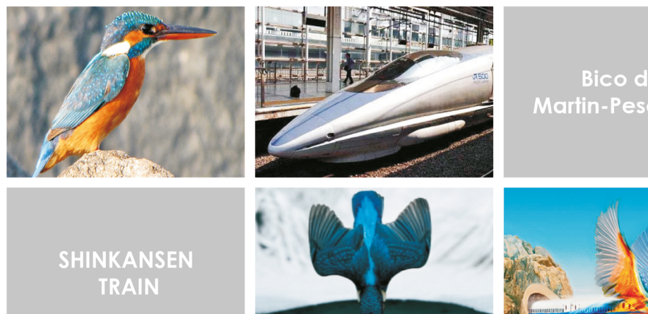
Figura 5. SHINKANSEN (Japão), trem-bala de alta velocidade mais rápido do mundo, redesenhado tendo como base o bico de um Martin-Pescador. Fonte: SOARES, 2016 apud VERSOS, 2010, p.33.
