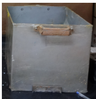
Figura 1 – Box foamer de laboratório e os blocos de espuma já fatiados em corpos de prova.
