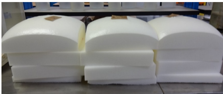
Figura 1 – Box foamer de laboratório e os blocos de espuma já fatiados em corpos de prova.
