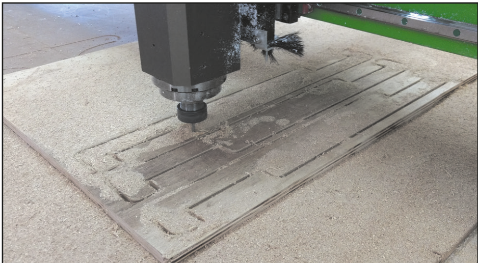
Figura 8.3 - Fabricação da quarta Régua Longa de Proteção (RELP) na Router CNC
