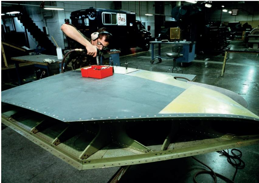
Figura 5: montagem de superfície de controle de aeronave
