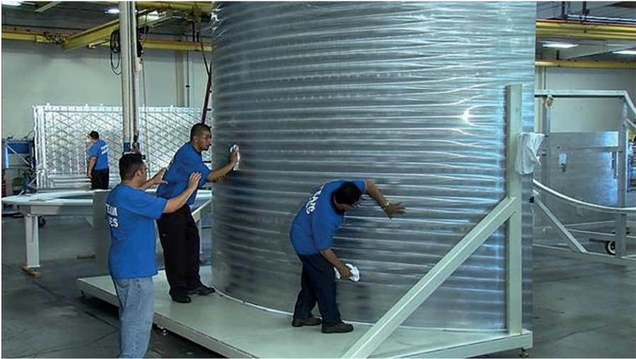
Figura 2: casca externa de foguete em montagem
