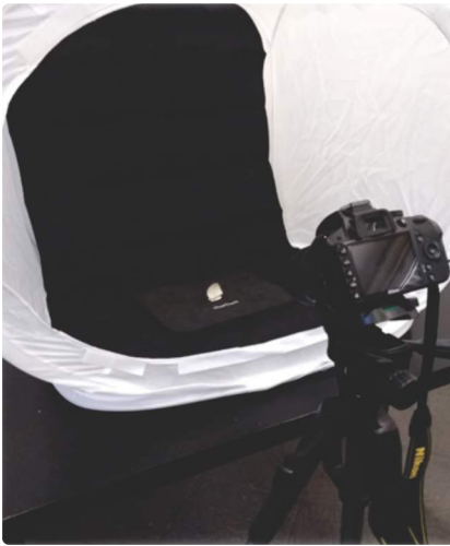
Fig. 2 Acquisizione fotogrammetrica della teca di P.lividus .
