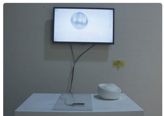
Figura 16 : Semotility, installazione interattiva, progettata e realizzata da Antonio Grillo e Filippo Sessa del FabLab Napoli, consente di manipolare, spostare, ingrandire e ridurre, con un sistema di gesture control che impiega una tecnologia leap motion, i modelli 3D delle diatomee elaborati dai designer Antonia Auletta e Giacomo Cesaro a partire dai SEM prodotti dai biologi nel corso della ricerca FIRB per le simulazioni scientifiche.
