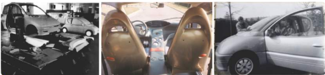
As fases do projeto Zic dos modelos em escala real, da prototipagem rápida e a produção de uma pequena série testada (onde que tive o prazer de dar uma volta) e que participou dos principais Salões de Automóvel na Europa 4 Fotos : arquivo pessoal e CRIED 1992
