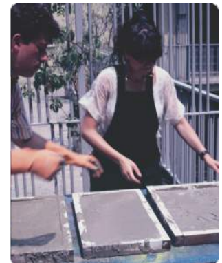
Fotos 5, 6, 7: CRIED Milán, Italia, 1987 – Realización de modelos de prueba para pavimentos sensibles y texturizados como guía para personas invidentes y para uso en la MM Metropolitana Milanese en colaboración con Artigo Pirelli Group S.p.A. Silvia Giampaola y Sergio F. Grijalva. Foto: Cortesía de Sergio F. Grijalva.
