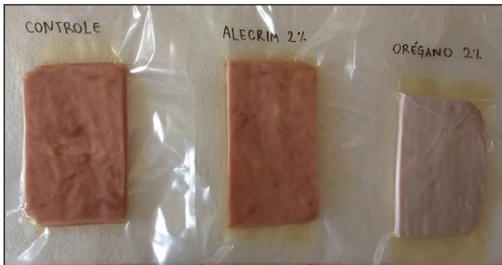
Figura 7- Presunto recoberto com os filmes FC, FO e FA e embalado a vácuo
