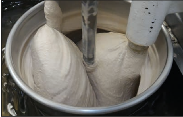
Figura 4 - Sorvete de alfarroba passando pelo processo de congelamento na sorveteira a -30 °C
