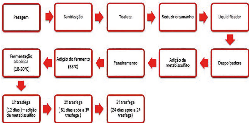
Figura 1 – Fluxograma do processo de elaboração da sidra com maçã Gala e Fuji
