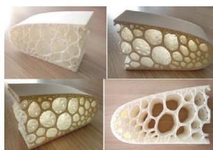
Figura 26: Impressão digital: protótipo da estrutura bioinspirada aplicada na borda de uma secção de um bloco de prancha de surf.
