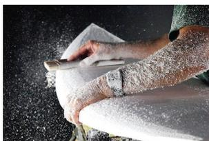
Figura 2: A confecção de uma prancha de surf ocorre através de processos de usinagem e laminação de materiais poliméricos termofixos, com altos índices de perda de matéria-prima. Fonte: <https://www.surftoday.com/surfing/11051-the-surfboard-brands-of-the-world>. 2018.
