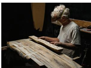
Figura 3: Utilização do Agave como matéria-prima alternativa para fabricação de pranchas de surf. Material orgânico alternativo que apresenta estratégias de leveza e resistência. Fonte: Surfline.com. 2018.
