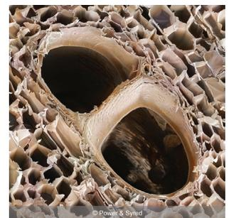
Figura 6: Seção transversal da madeira de balsa. Fonte: <https://psmicrographs.com/sems/flowers-plants/>. 2018.
