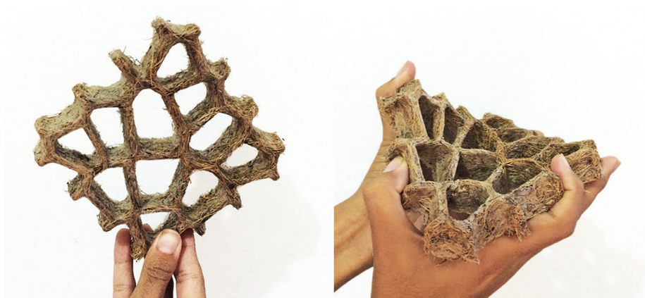
Figuras 8 e 9: A esquerda, elemento (escala 1:5) ao ser retirado da fôrma. A direita, as propriedades da resina permitem curvatura do elemento.
