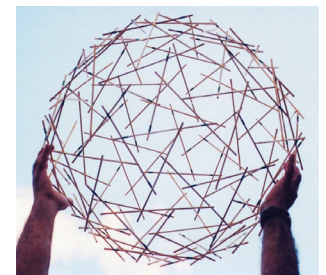
Figura 23: Modelos de estruturas geodésicas em sistema de tensão integral (tensegrity) desenvolvidas no LILD (a) Icosaedro tensegrity. (b) Geodésica tensegrity frequência 2V.
