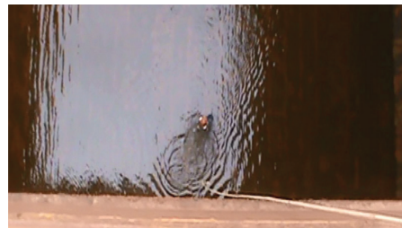
Figura 55 Ações para coleta de amostra de água de lastro a bordo dos navios. A) Procedimento para abertura de tanques do convés. Durante esta operação foram gastos cerca de 15 minutos em função do estado das porcas de abertura do tanque. B) Coleta de amostra por meio do tubo de sondagem do tanque. C) coleta de amostra com a rede de fitoplâncton dentro do tanque. D) coleta de água de lastro do tanque de carga do navio
