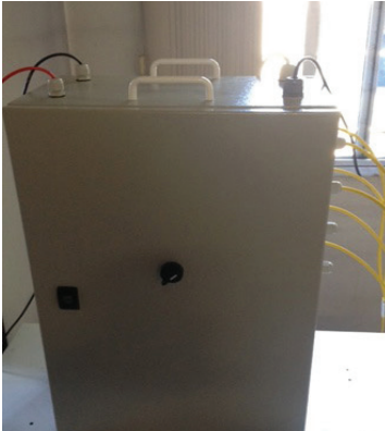
Figura 60 Sistema de monitoramento da água de lastro encapsulado
