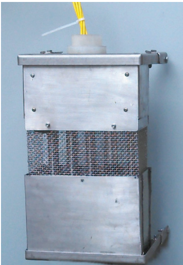
Figura 61 Gaiola desenvolvida para suporte dos sensores e fixação dentro do tanque de lastro
