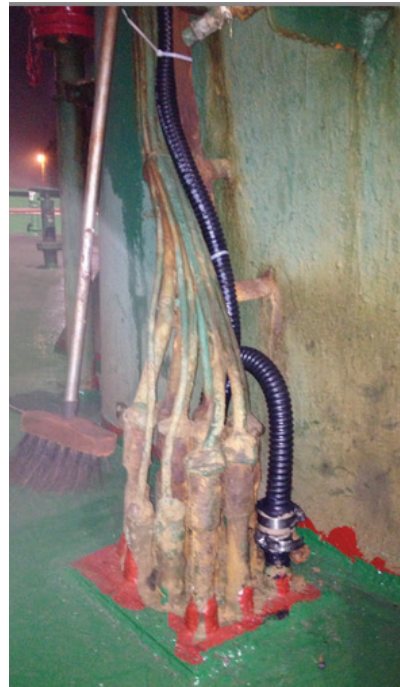
Figura 66 Instalação dos equipamentos no mastro do navio e passagem dos cabos para a parte interna do paiol do mestre
