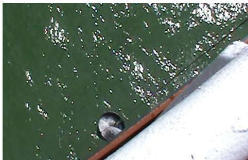
Figura 56 Dificuldade de acesso e coleta da água de lastro. E) devido à dificuldade de acessar o tanque a água de lastro foi coletada pelo convés do navio durante o processo de deslastre do navio junto ao porto. F) acesso ao tanque de lastro pelo convés
