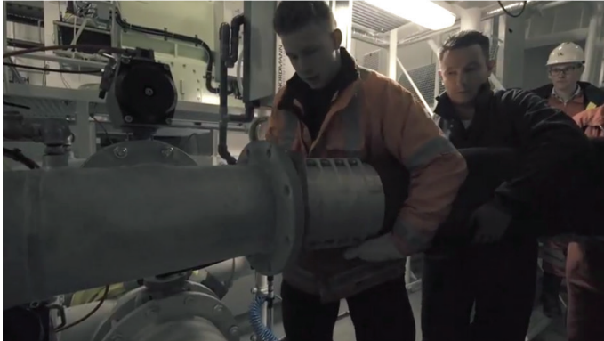
Figura 34 Sistema de conexão da mangueira para realização da coleta da água de lastro do navio 4
