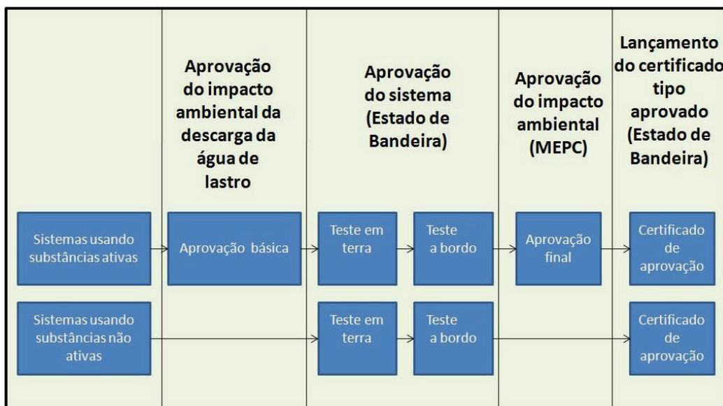
**Figura 10** Procedimento para aprovação de sistema de tratamento de água de lastro
