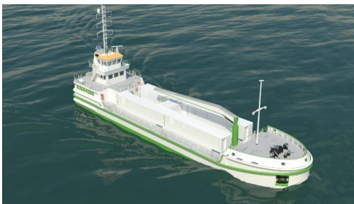
Figura 30 Protótipo de Barcaça para coleta e tratamento da água de lastro no porto
