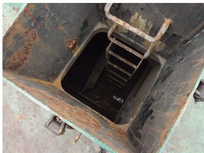
Figura 56 Dificuldade de acesso e coleta da água de lastro. E) devido à dificuldade de acessar o tanque a água de lastro foi coletada pelo convés do navio durante o processo de deslastre do navio junto ao porto. F) acesso ao tanque de lastro pelo convés
