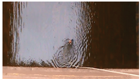
Figura 55 Ações para coleta de amostra de água de lastro a bordo dos navios. A) Procedimento para aberto de tanques do convés. Durante esta operação foram gastos cerca de 15 minutos em função do estado das porcas de abertura do tanque. B) Coleta de amostra por meio do tubo de sondagem do tanque. C) coleta de amostra com a rede de fitoplâncton dentro do tanque. D) coleta de água de lastro do tanque de carga do navio
