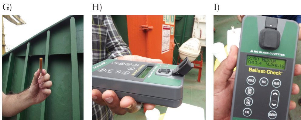
Figura 58 Exemplo de utilização do Ballast-Check. A) Coleta de amostra de água de lastro. B) inserção da amostra no aparelho. C) Resultado apresentando o grau de risco medido pela amostra analisada
