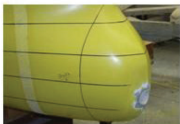
Figura 19 Modelos utilizados na validação do método Ballast-Free durante os ensaios em tanques de prova para medir os coeficientes hidrodinâmicos
