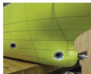
Figura 19 Modelos utilizados na validação do método Ballast-Free durante os ensaios em tanques de prova para medir os coeficientes hidrodinâmicos
