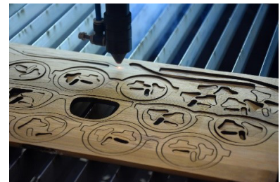
Figura 21: Corte a laser de protótipos finais. Fonte: o autor.
