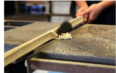
Figura 13: Retirada dos nós com serra circular de mesa. Fonte: Barbara Miotto.
