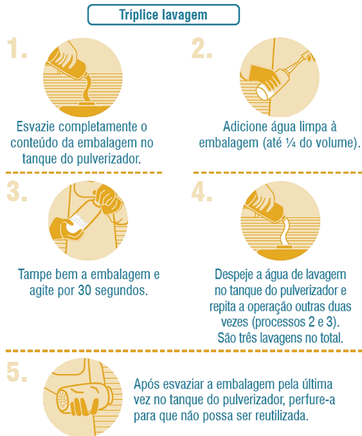
Figura 4. Tríplice lavagem de embalagens de agrotóxicos, procedimento exigido pelo IBAMA e ilustrado pelo inpEV (2025) 17
