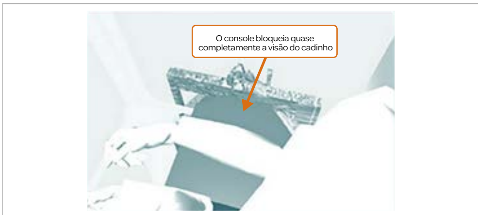
Figura do Anexo 1.2 Vista que o operador tem de um cadinho localizado a 2,3 m da parede no caso do projeto da cabine, equipada com assento fixo.
