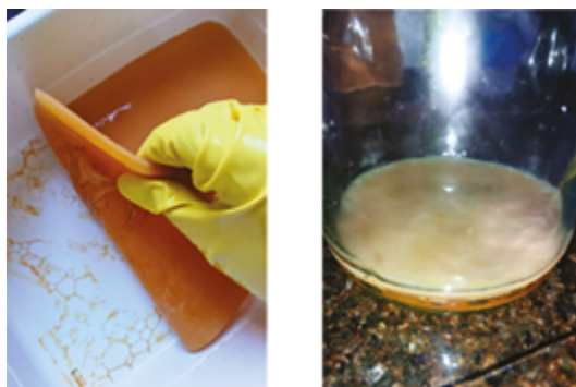
Figura 5 Da esquerda para a direita: a) Celulose bacteriana proveniente de chá preto; b) Celulose bacteriana com coloração esbranquiçada, proveniente do chá verde.
