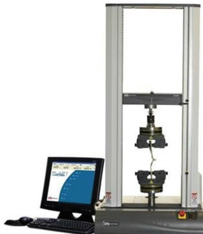
Figura 3 – Máquina universal de ensaios, Modelo Instron 3360
