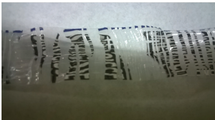
Figura 5 – Filme coextrusado após alongamento
