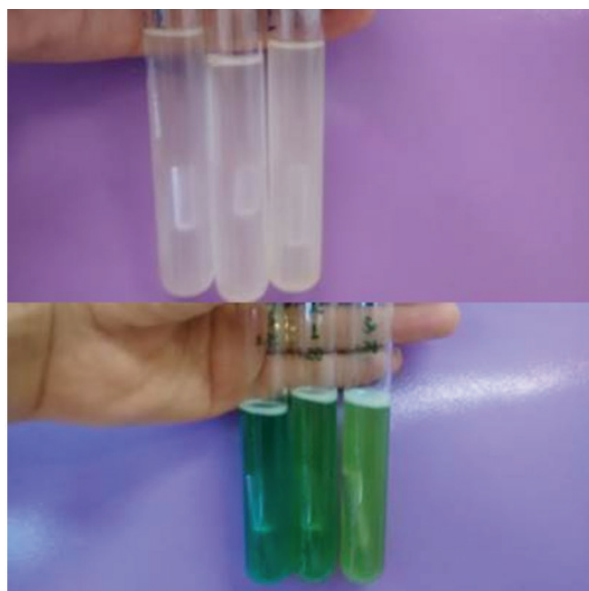
Figura 6 – Formação de gás em tubos, presença de coliformes totais e termotolerantes na amostra de alface
