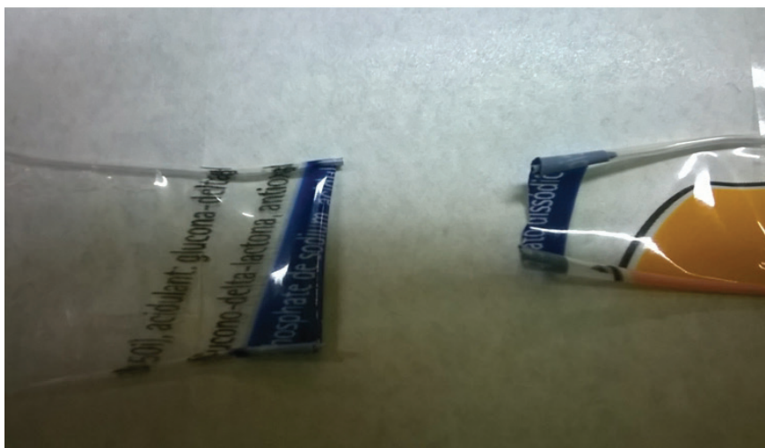
Figura 4 – Filme laminado após alongamento
