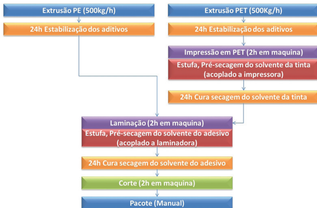
Figura 1 – Fluxograma de fabricação do filme flexível de PET/PE laminado
