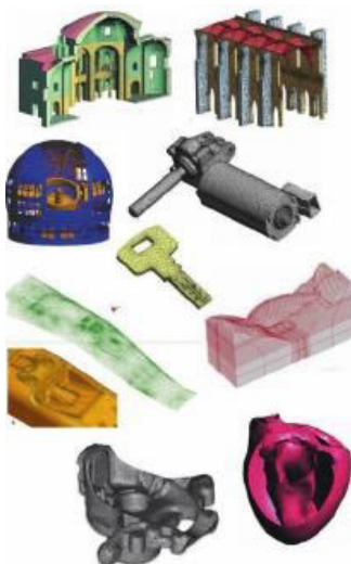
Figura 24 – Discretização de diferentes sólidos e estruturas com o MEF, (ONÂTE, 2009)
