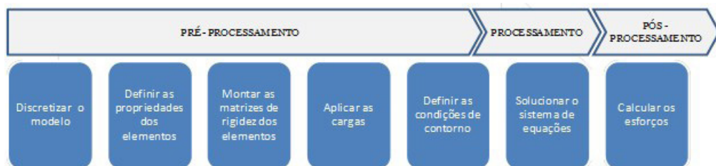
Figura 23 – Passos para solução em Elementos Finitos
