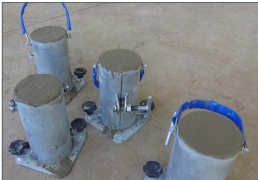
Figura 2 – Corpos de prova modelados nas fôrmas cilíndricas com suas superfícies acertadas (Fonte: Autoria própria).
