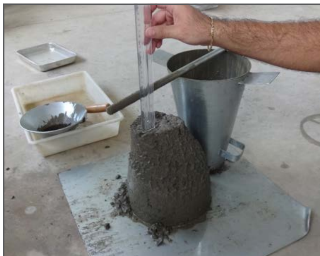
Figura 1 - Medida do abatimento do tronco de cone com o auxílio de uma régua milimetrada (Fonte: Autoria própria).
