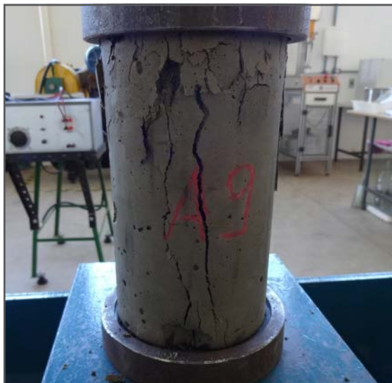
Figura 3 – Corpo de prova após ruptura em prensa hidráulica (Fonte: Autoria própria).
