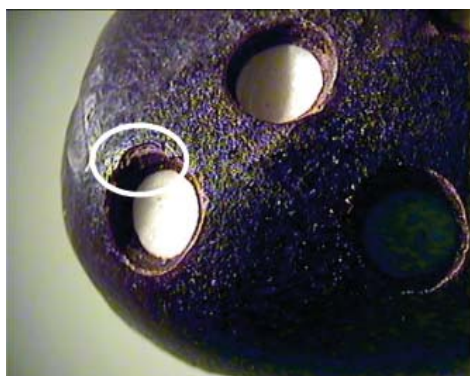
Figura 62 detalhe do “defeito” causado pela quebra da superfície da semente de jatobá com a utilização do escariador.
