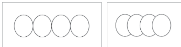
Figura 81 à esquerda, posicionamento comum das sementes de açaí em fio e à direita, o novo posicionamento após o teste.
