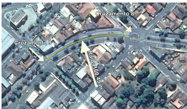
Figura 19.1 Exemplo de cálculo da distância da curva ao cruzamento e valor do raio.
