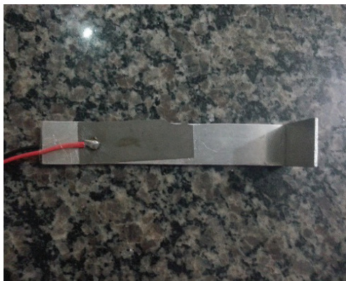
Figura 24.3.a Placa sem parafuso (placa em perfeito estado).
