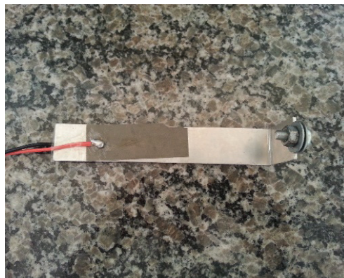
Figura 24.3.b Placa com parafuso (simulando a falha).
