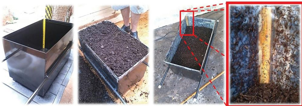
**Figura 3.4** Determinação do volume na pré-compostagem.
